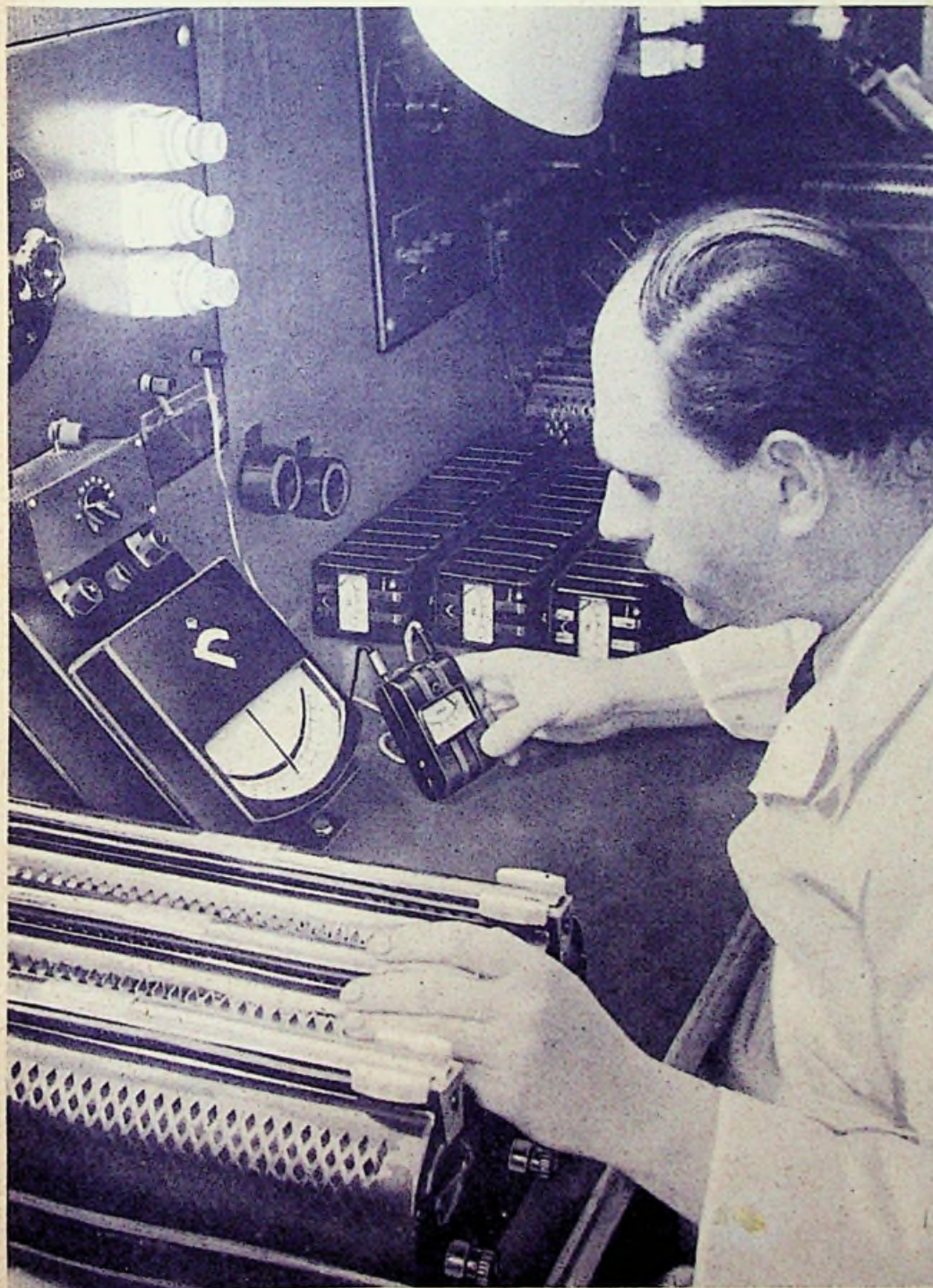
Die Meßgeräde-Industrie nimmt die Abgleichung von Ohmmetern mit besonderer Sorgfalt vor, da hiervon die Genauigkeit der Messungen in vielen Werkstätten abhängt. Unser Bild zeigt den Abgleichvorgang des Triohm, eines bekannten Ohmmeters, das in großen Stückzahlen gefertigt wird. (Werkfoto: P. Gossen)
